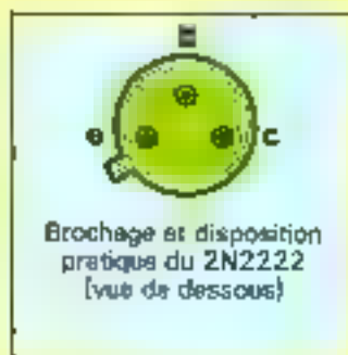
Fig. 5 - Le brochage du transistor 2N2222 (vu de dessous).
